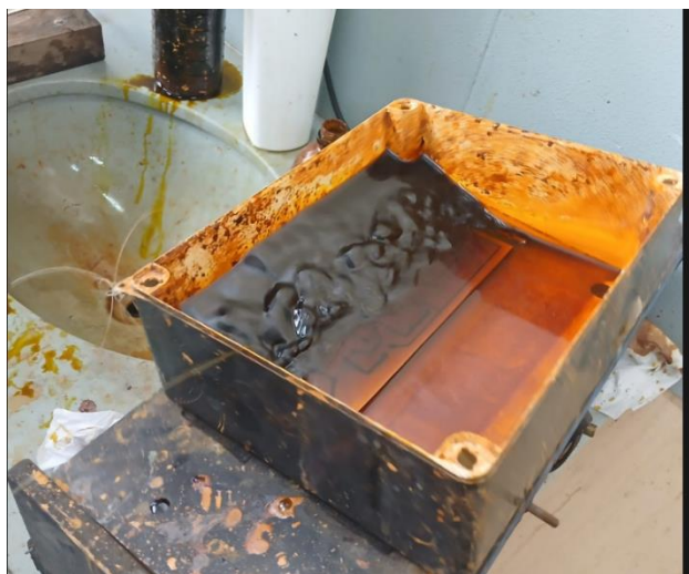
Figura 33- PROCESSO DE CORROSÃO DA PCB
