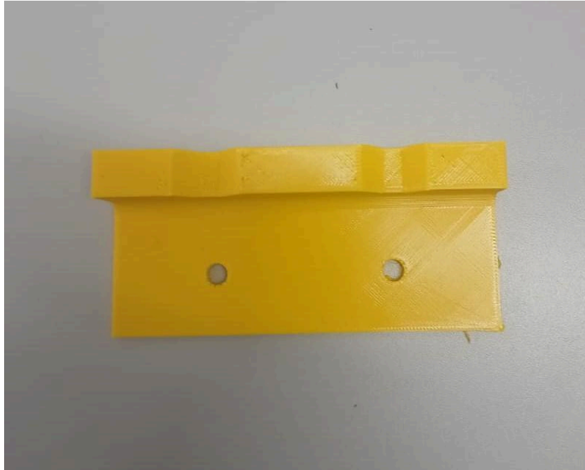
Figura 8 - Peça finalizada após a impressão 3D
