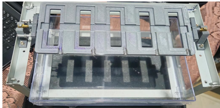
Figura 11- Equipamento para coloração de Gram com suporte para 5 lâminas de microscopia
