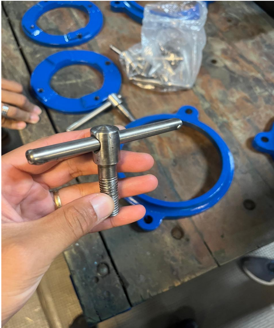
Figura 5 - Parafuso usinado em torno mecânico para reposição nas morsas de bancada.
