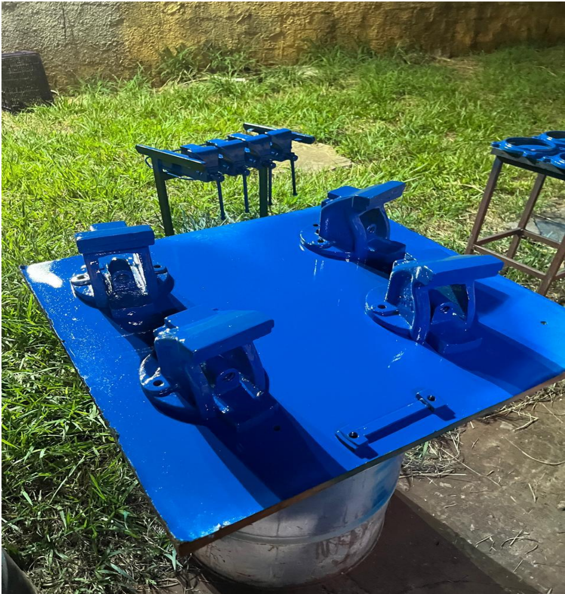
Figura 6 - Morsas de bancada após aplicação da pintura com pistola de ar comprimido.
