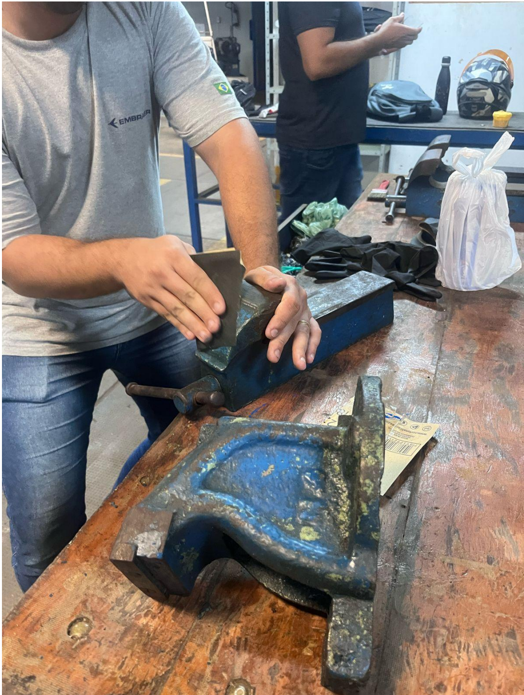
Figura 4 - Lixamento manual das morsas de bancada com lixa grana 180
