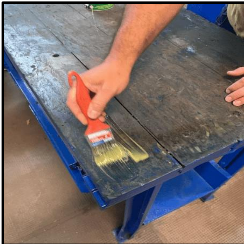
Figura 6 – Aplicação da cola na bancada
