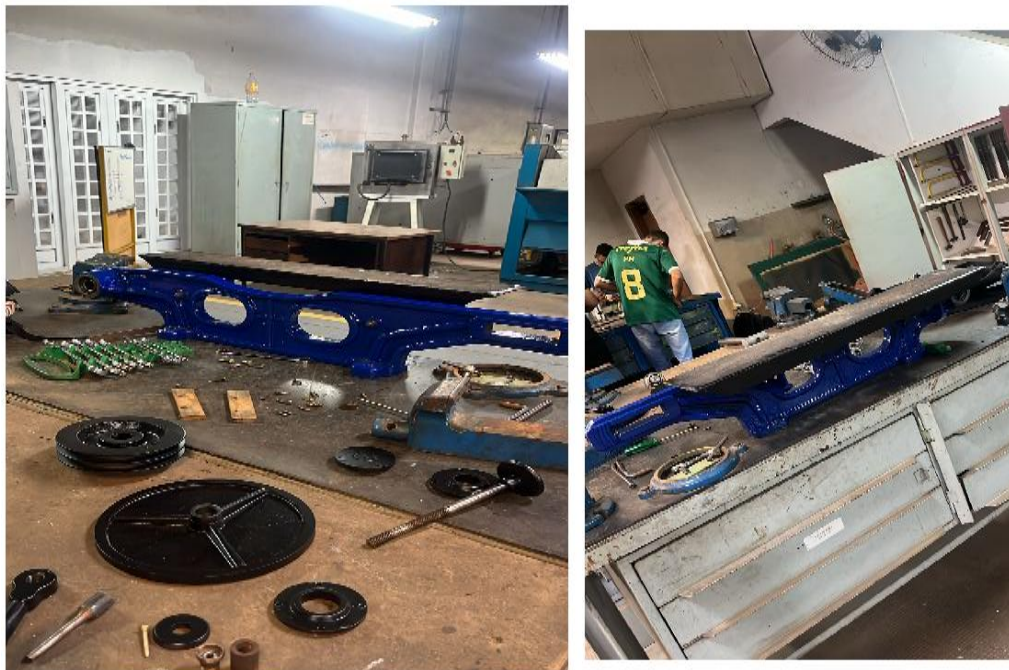
Figura 5 – Montagem da lixadeira
