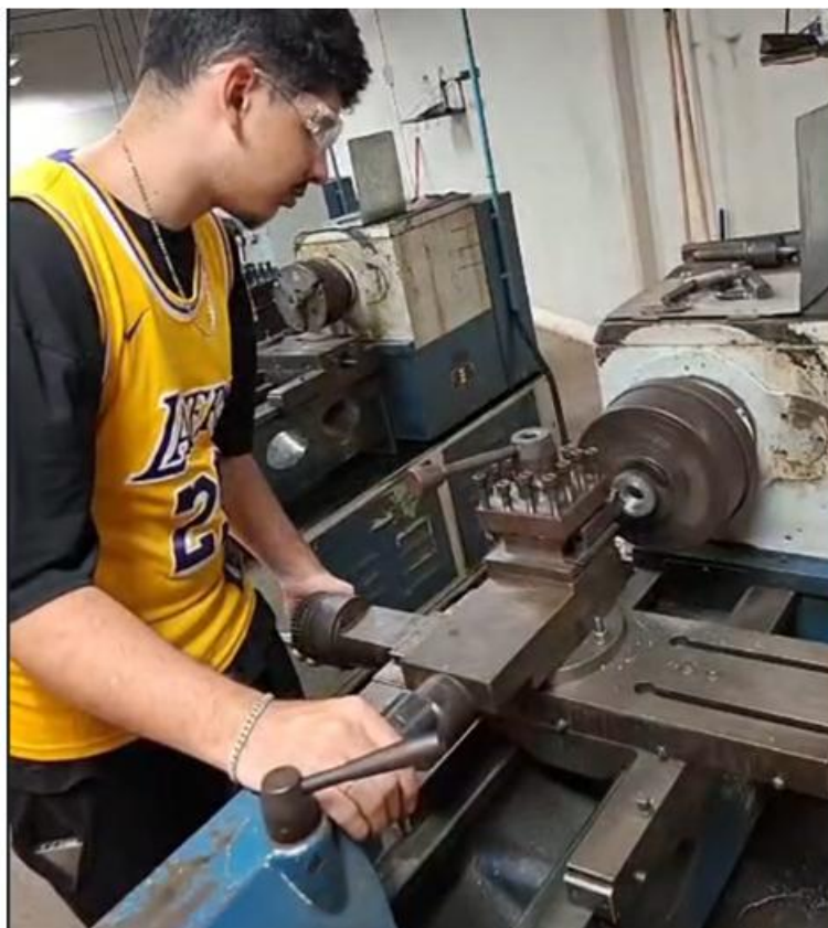
Figura 4 – Usinagem de um novo espaçador
