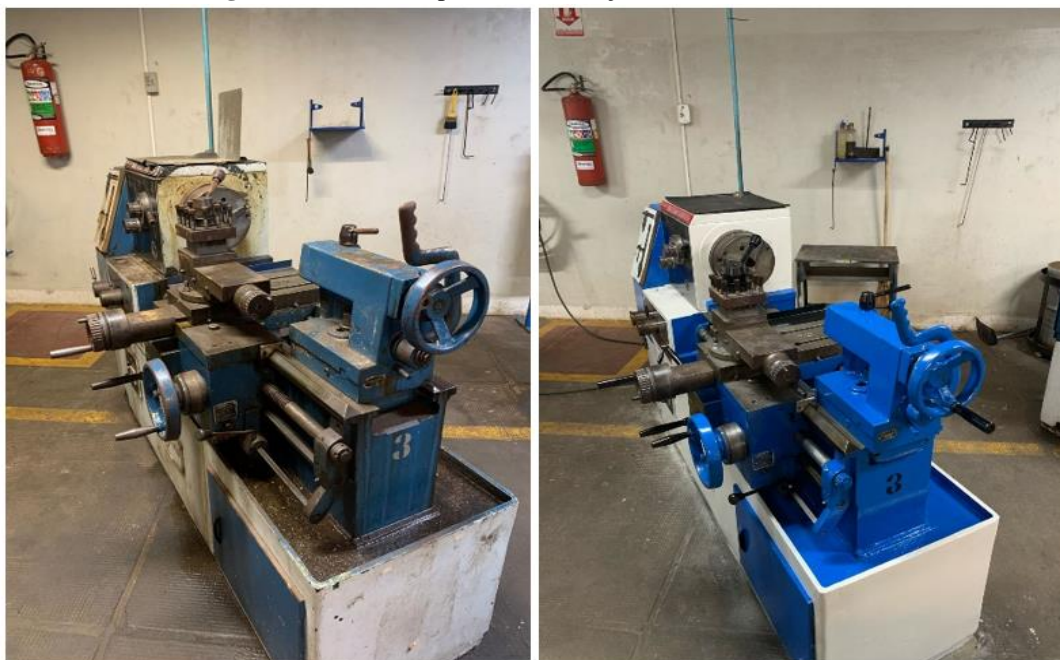
Figura 5 – Antes e depois da restauração do torno Nardini 500
