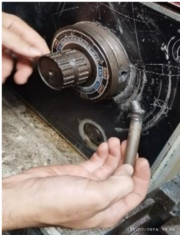
Figura 8 – Remoção das Peças Avariadas
