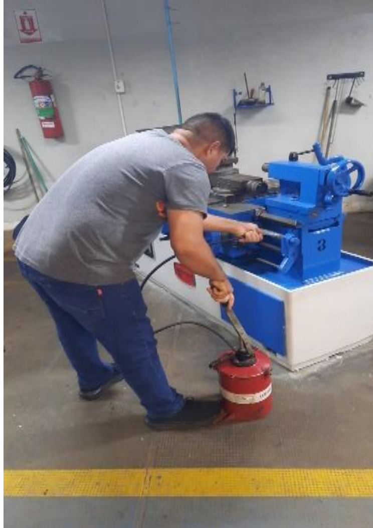
Figura 7 - Lubrificação do Torno
