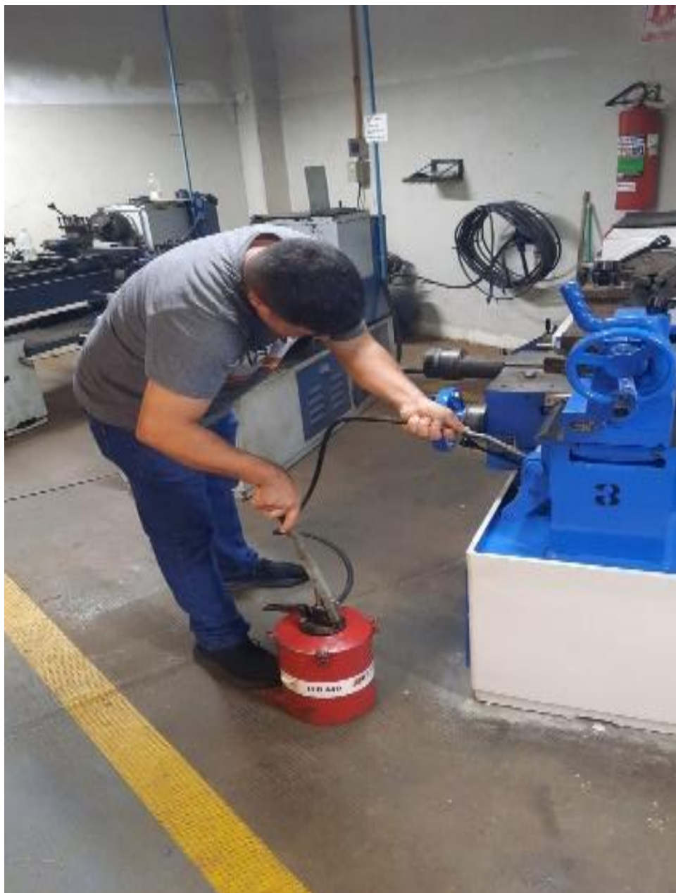
Figura 6 - Lubrificação do Torno
