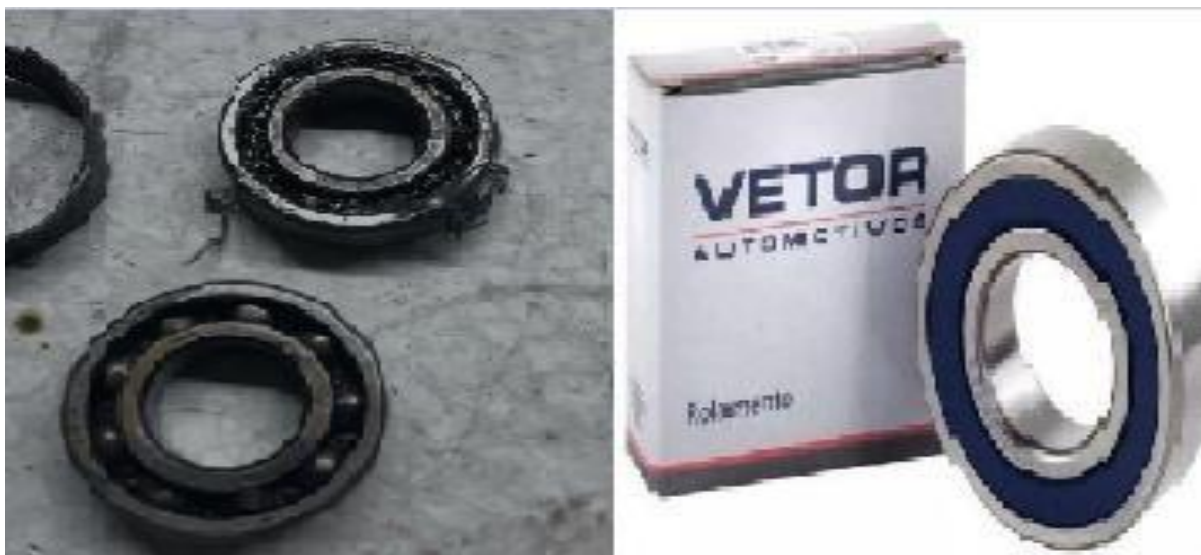
Figura 6: Troca de rolamentos danificados
