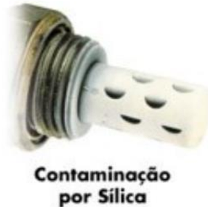
Figura 48 – Contaminação por sílica
