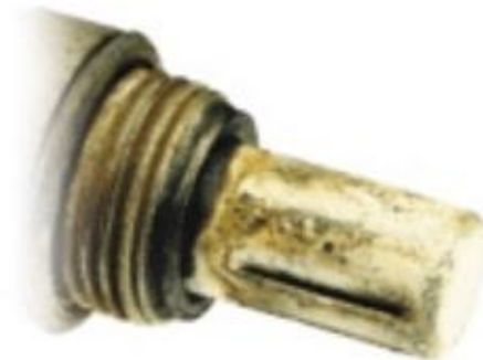
Figura 47 – Contaminação por líquido de arrefecimento
