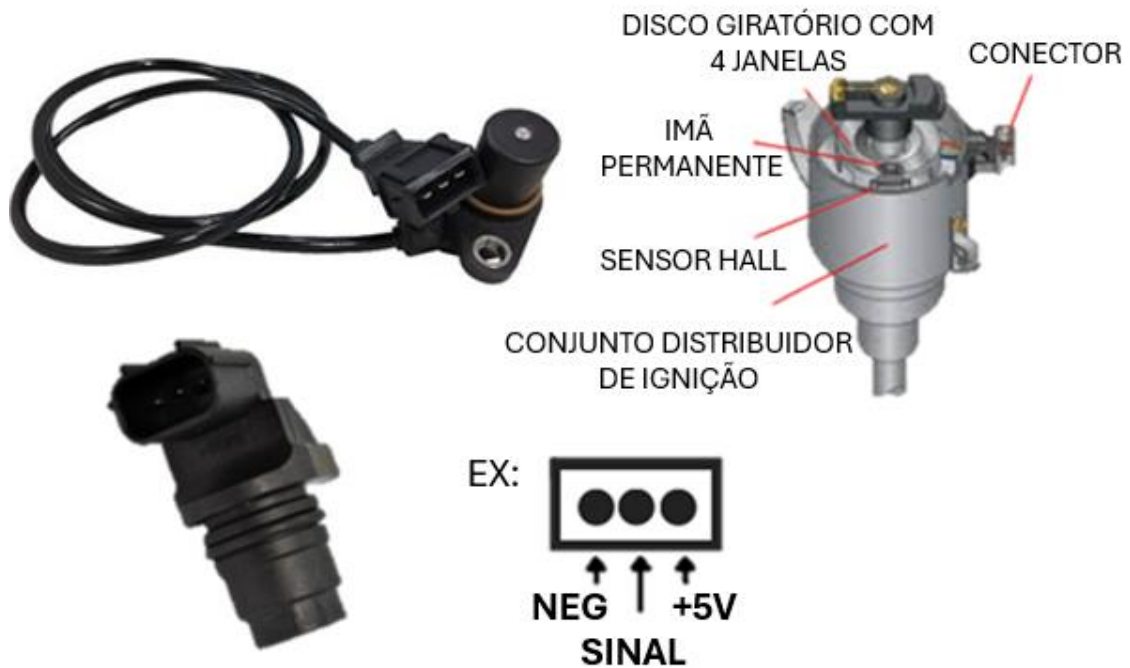
Figura 21 – Construção do sensor Hall
