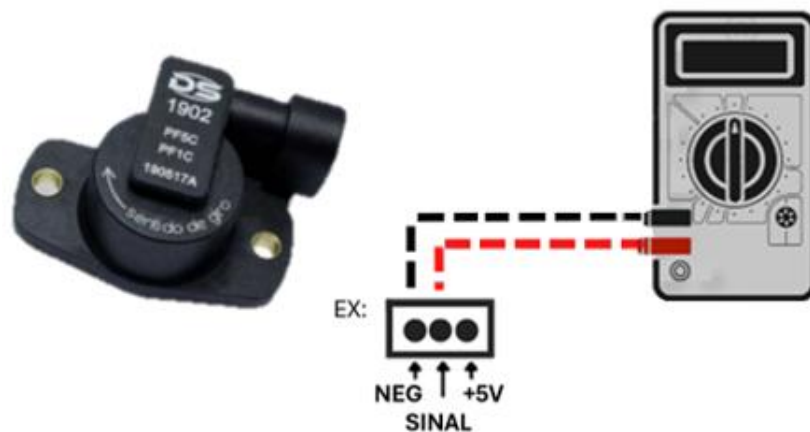
Figura 34 – Teste de resistência do sensor TPS tipo potenciômetro
