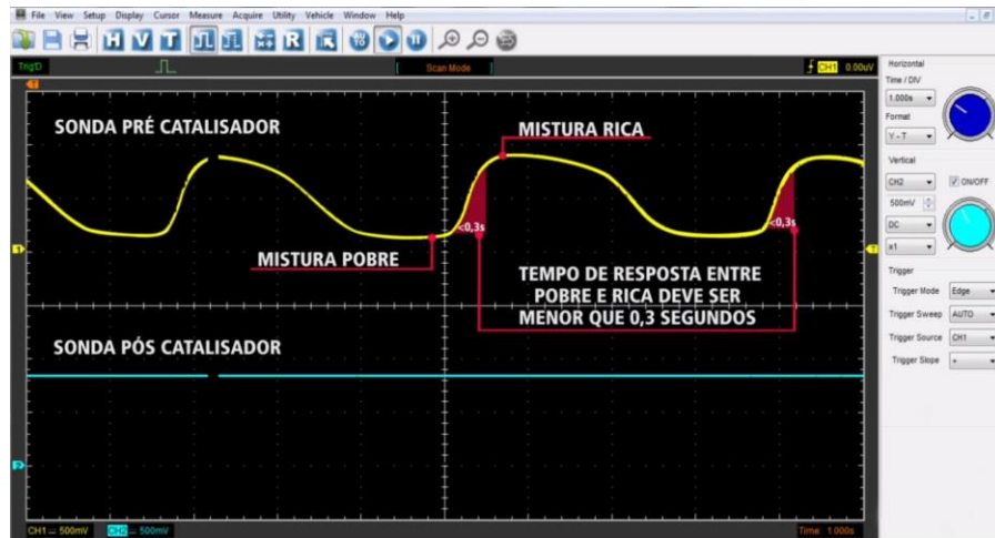
Figura 55 – Teste de sinal sonda banda estreita
