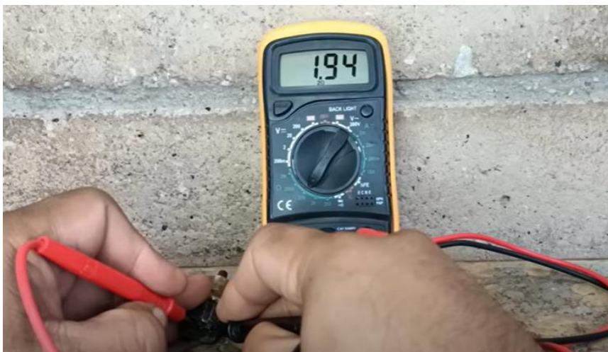
Figura 58 – Teste de continuidade
