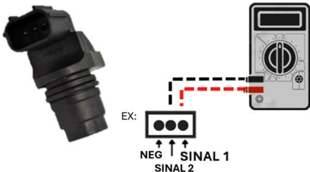
Figura 28 - Teste frequência do sensor de fase e rotação (Tipo Hall)
