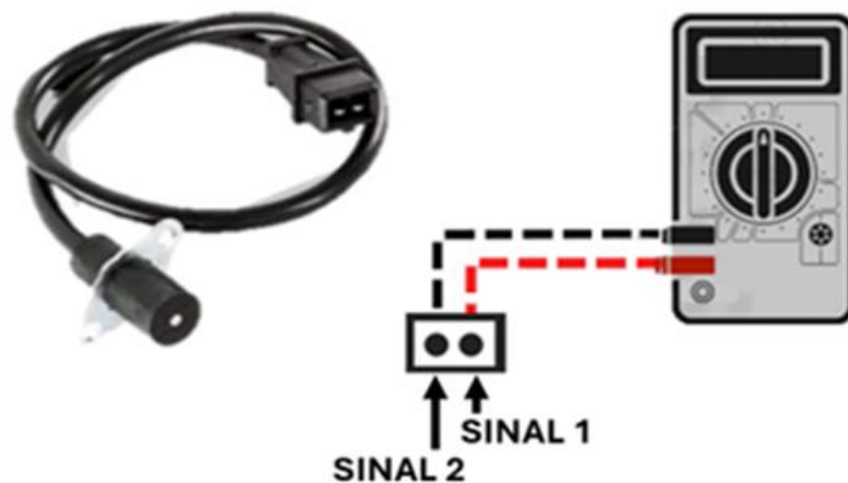
Figura 24 – Teste de resistência do sensor de fase e rotação 2 fios (Tipo Indutivo)
