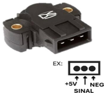
Figura 33 – Sensor TPS Resistivo 3 fios
