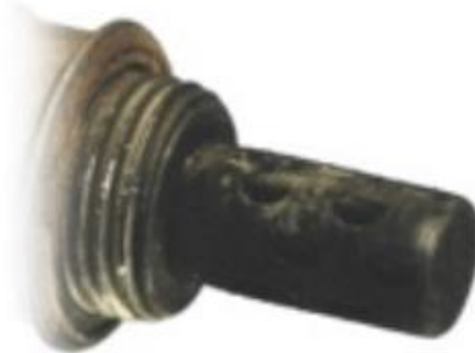
Figura 46 – Contaminação por mistura rica
