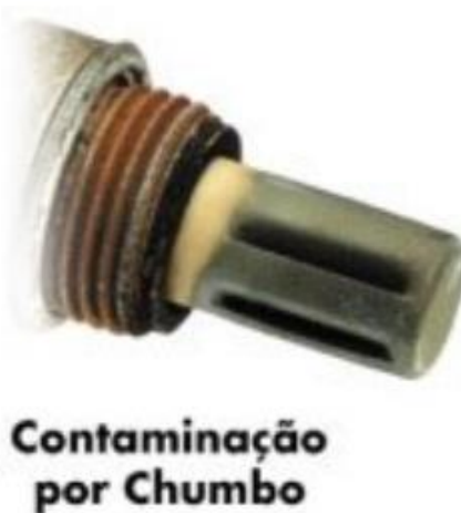
Figura 49 – Contaminação por chumbo
