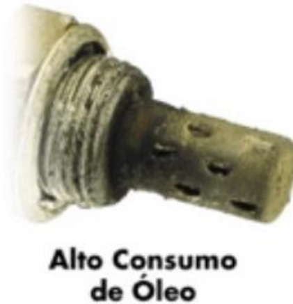
Figura 50 – Contaminação por consumo de óleo
