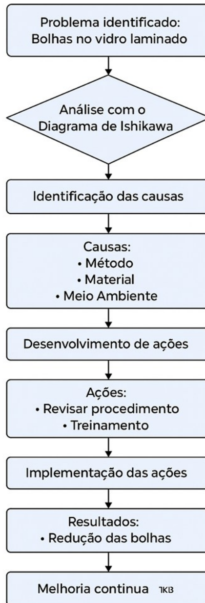
Figura 2- Fluxograma de resolução de um problema de qualidade (bolhas no vidro laminado) utilizando o Diagrama de ISHIKAWA
