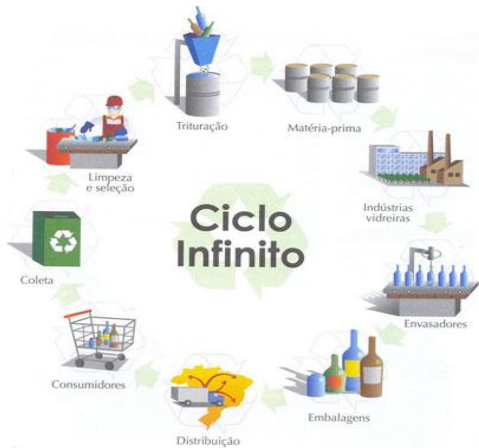
Figura 2 – Ciclo da reciclagem do vidro
