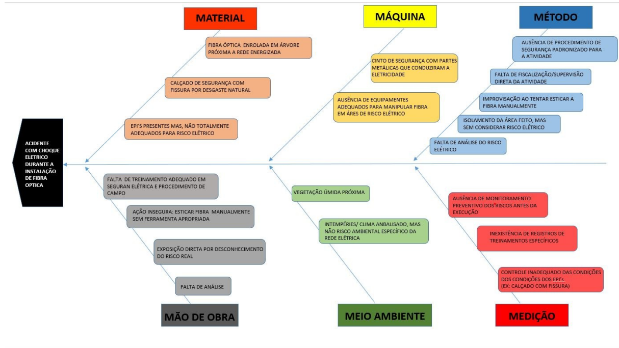
Figura 2 – Diagrama de Ishikawa do acidente por choque elétrico durante instalação de fibra óptica
