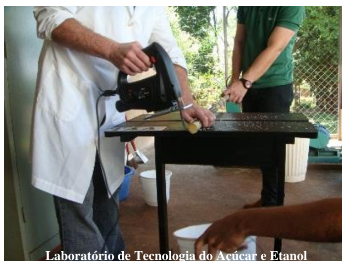
FIGURA 6: Cana sendo cortada em Nó e Entrenó utilizando a serra tipo 'Tico-Tico'
