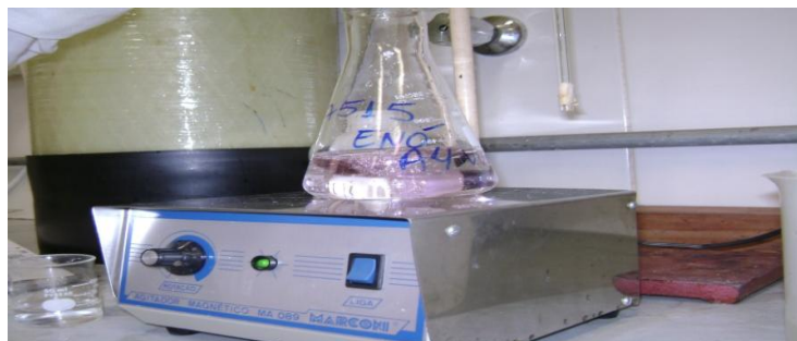
FIGURA 13 – Titulação com a solução de NaOH do caldo destilado.
