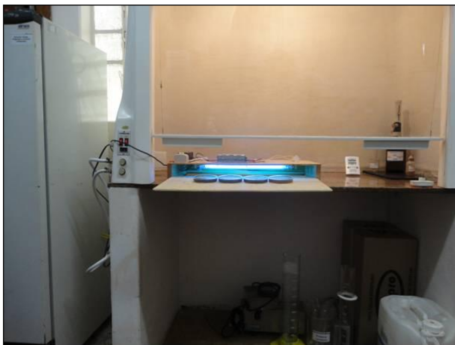
FIGURA 2 - Protótipo utilizado para aplicação de luz ultravioleta em placas de Petri contendo 50mL e 1cm de altura de caldo, Araraquara-SP, safra 2010/2011.
