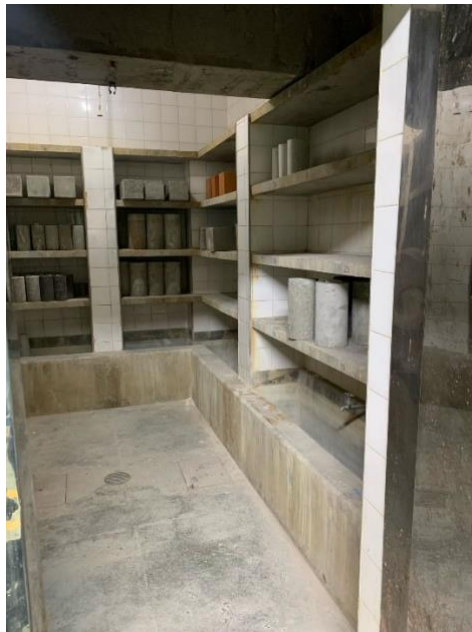
Figura 21. Câmara úmida - Laboratório de materiais, piso térreo
