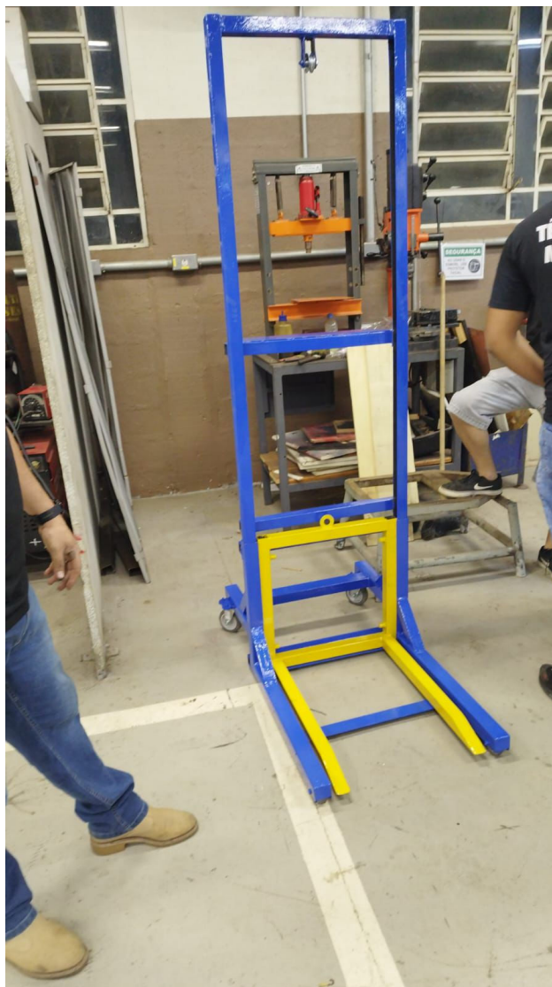
Figura 6: Pintura da estrutura finalizada.
