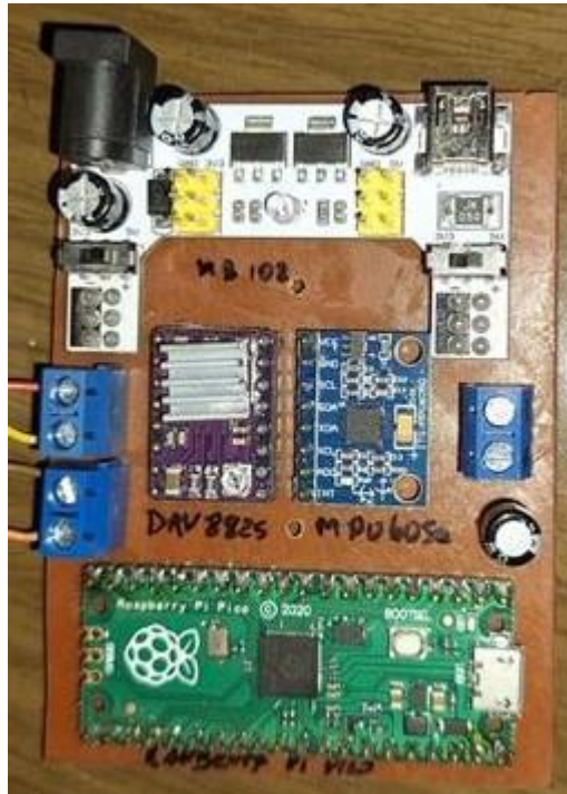
Figura 20 - Componentes na placa PCB
