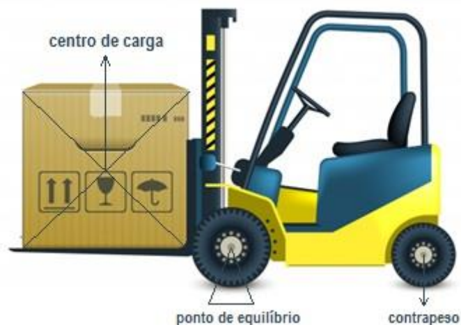
Figura 6 - Ponto de equilíbrio da empilhadeira
