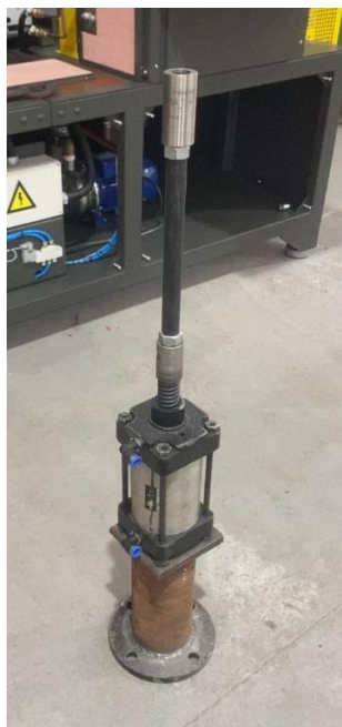
Figura 04 – Pistão pneumático com base e prótese no êmbolo
