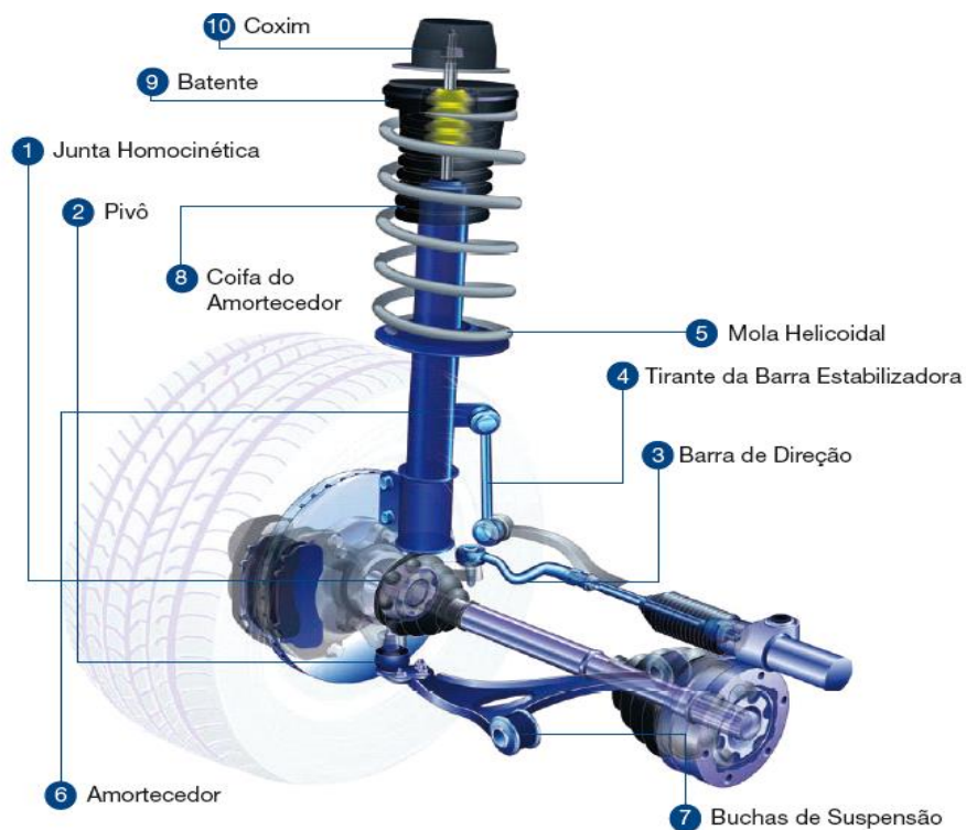
Figura 2 Suspensão de molas helicoidal (AUTOGLASS, 2020)
