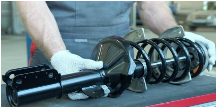
Figura 5 Mola helicoidal com amortecedor (COFAP, 2022)
