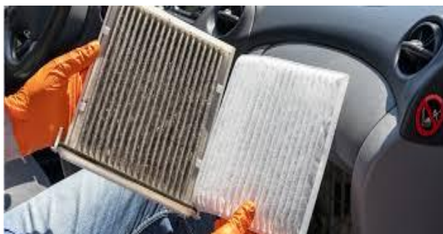
Figura 18 - Filtro de pólen com sujeira e poeira
