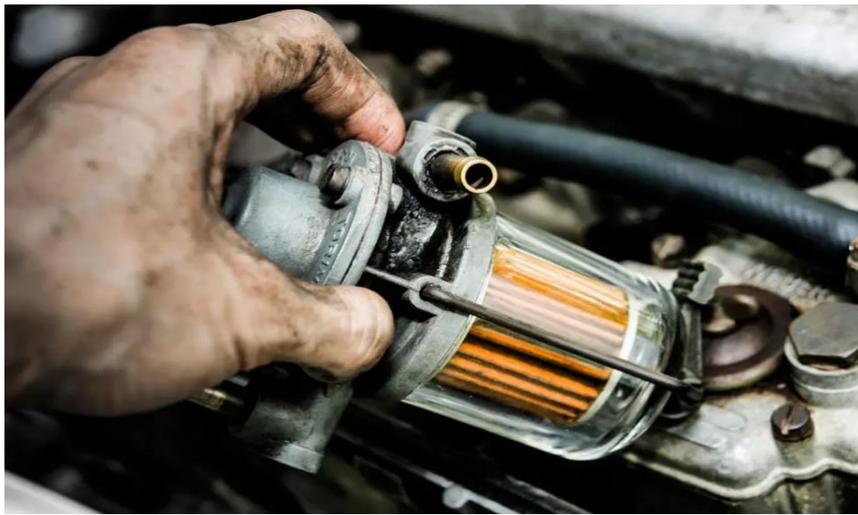
Figura 17 - Filtro com acúmulo de sujeira
