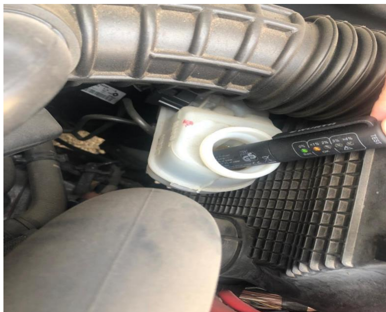
Figura 6 - Aplicação da caneta de teste de fluido de freio
