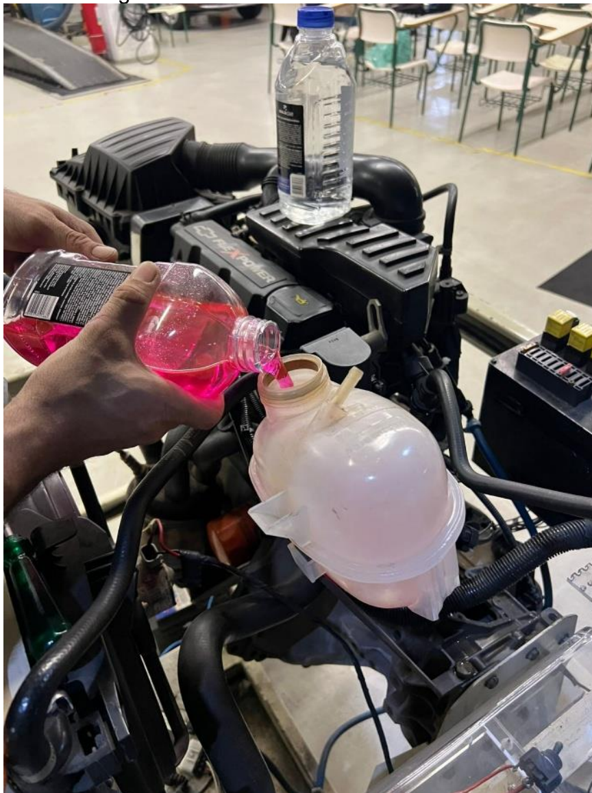
Figura 34- Abastecimento do reservatório
