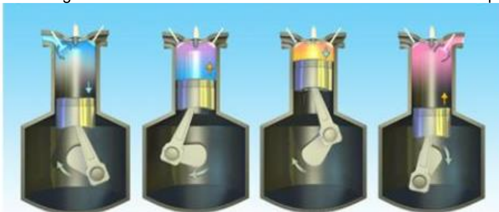
Figura 2- Funcionamento de um motor à combustão de 4 tempos
