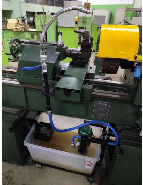
Fig.2 – Sistema de refrigeração
