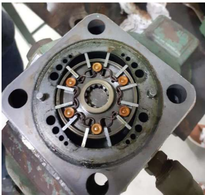
Imagem 2: Componente retirado e desmontado da bancada com óleo contaminado – Fonte: Autor
