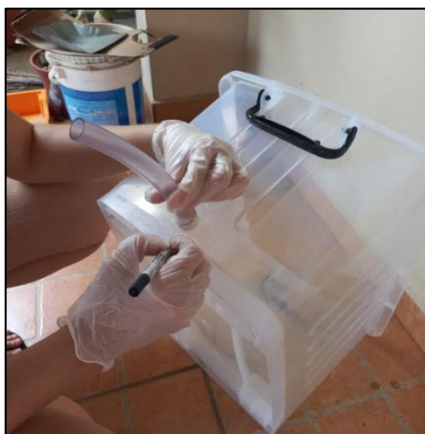
Figura 16 - Acoplamento da mangueira e tule no adaptador de PVC
