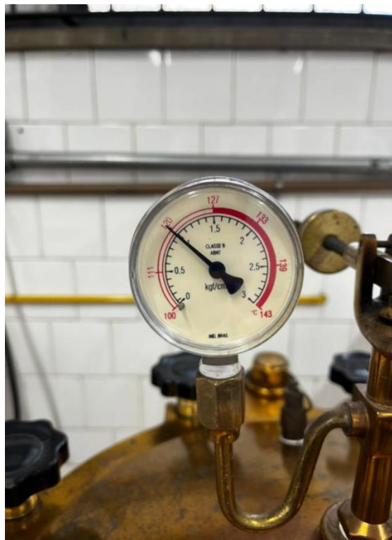
Figura 13 - Medidor de temperatura da autoclave (120°C). Fonte: AUTORIA PRÓPRIA.
