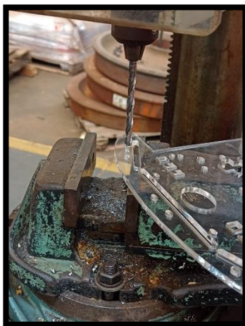
Figura 9a – furos no chassi
