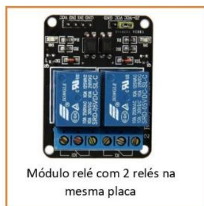
Figura 35 - Módulo de relé
