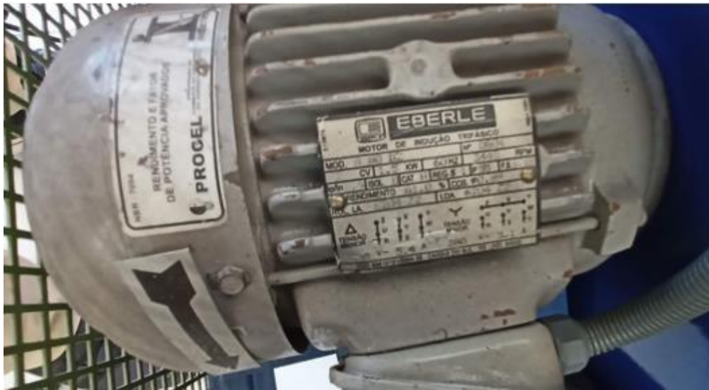
Figura 9: Motor trifásico que impulsiona o sistema.
