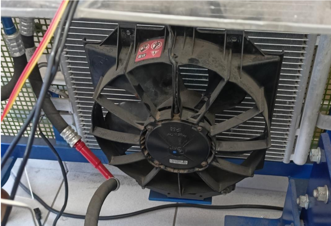
Figura 12: Conjunto condensador e ventilador do sistema.
