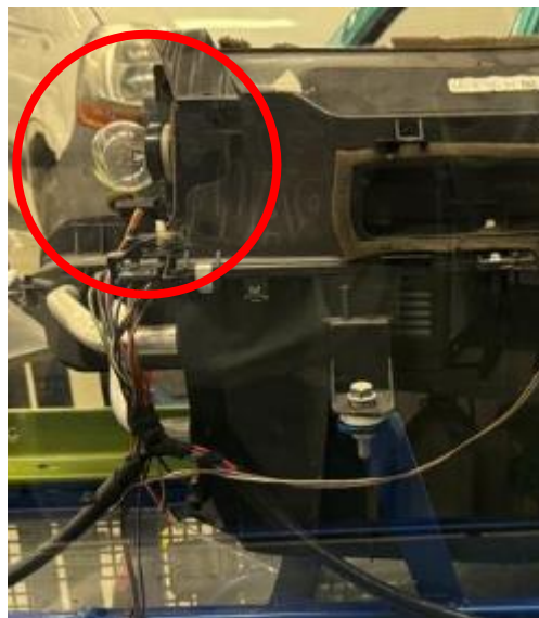
Figura 14: Posição do sensor LM35.
