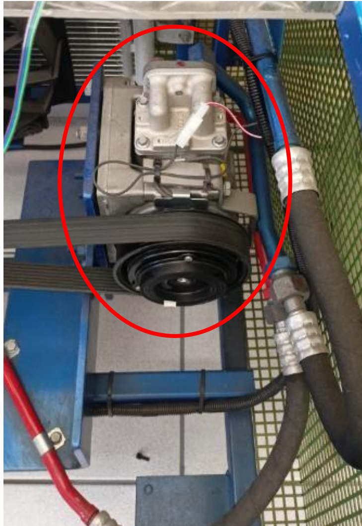
Figura 10: Compressor de ar-condicionado do sistema, destacado em vermelho.
