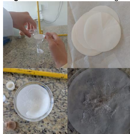
Figura 10 – Processo de filtragem.
