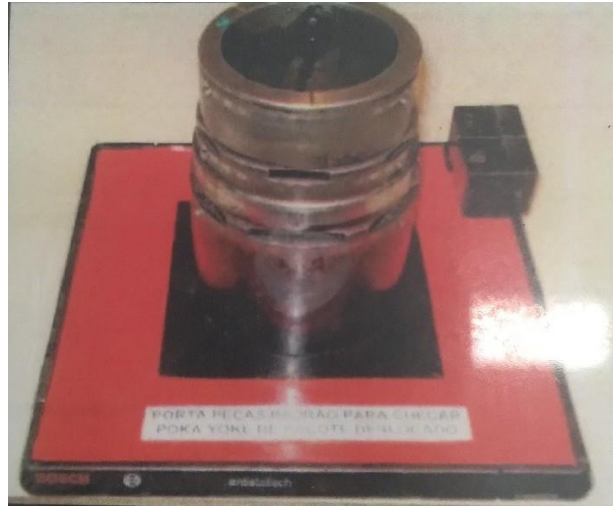
Figura 2: Pallet padrão, para verificação do defeito. Fonte: Autores
