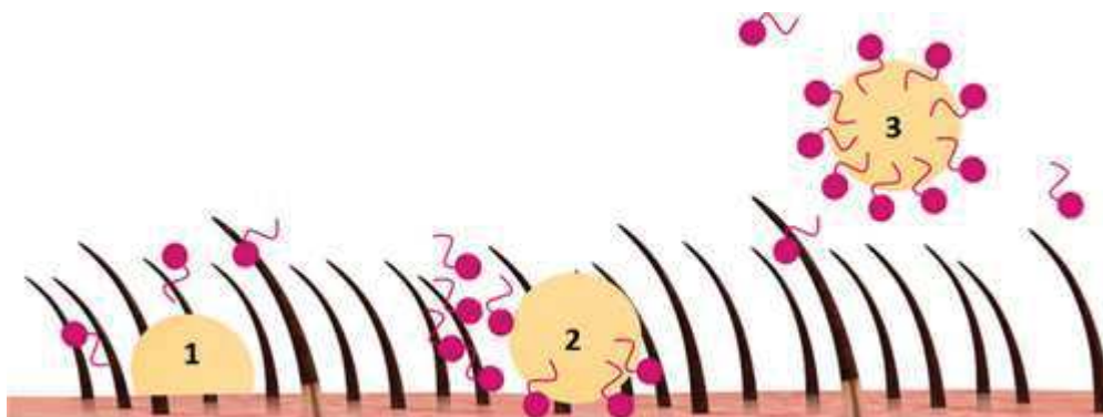
Figura 3 – Diagrama esquemático do mecanismo de “enrolamento” na remoção de resíduo aderente mediada por surfactante, baseado em dados de Muherei et al., Lochhead e Childs et al.
