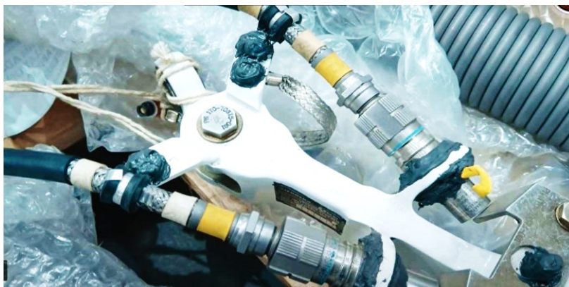
Figura 6: Sensor indutivo do trem de pouso, WoW
