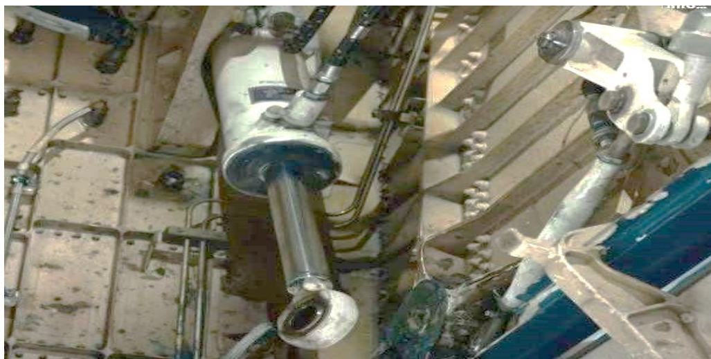
Figura 1: Cilindro responsável por fazer o trem de pouso subir
