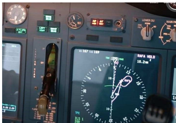
Figura 9: Luz acesa verde do trem de pouso Boeing 737
