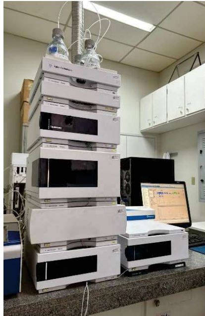
Figura 10: Cromatógrafo Líquido de Alta Eficiência (HPLC) acoplado a um detector de Arranjo de Diodos (DAD).
