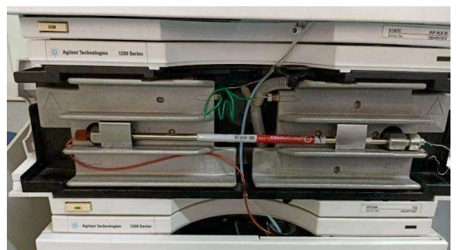
Figura 11: Coluna cromatográfica C 8 (2) LUNA Phenomenex (250 mm × 4,6 mm).
