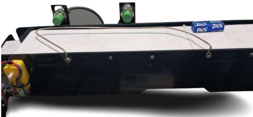
Ilustração 41: Posicionamento correto dos bombons na Esteira 2.
