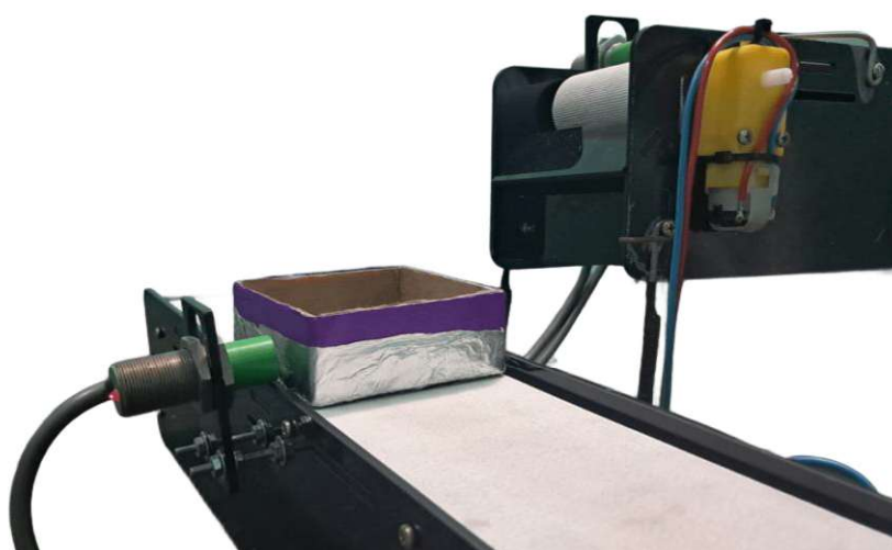
Ilustração 42: Alinhamento adequado das caixas na Esteira 1
