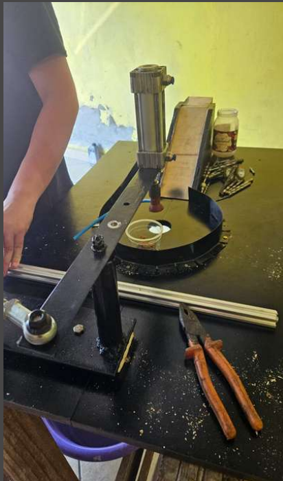
INSTALAÇÃO DOS PISTÕES NA BASE
