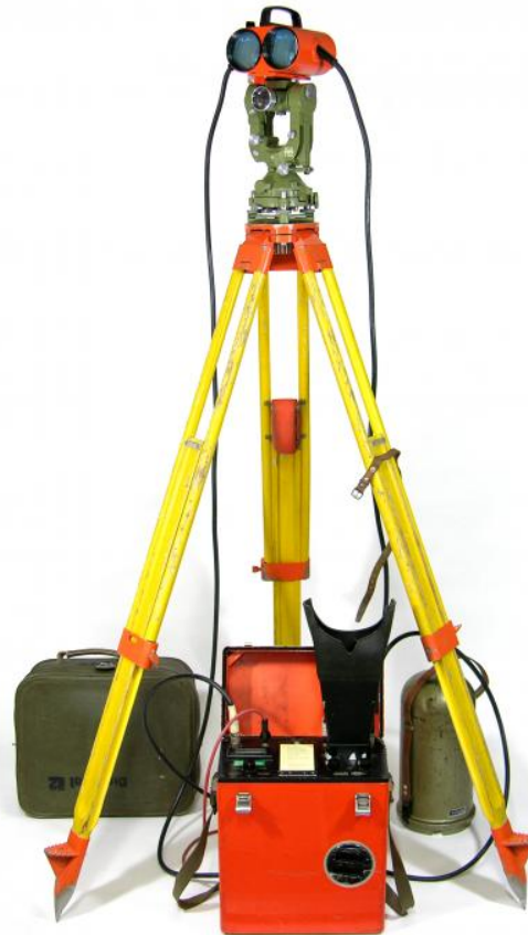
Figura 5 - Distanciômetro Wild DI10 acoplado sobre um teodolito Wild T2
