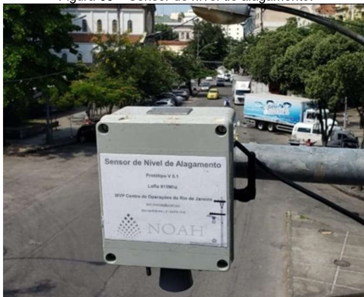
Figura 60 – Sensor de nível de alagamento.
