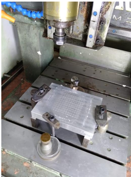
Figura 20 – Esquema de fixação da lâmina de Al sobre a mesa fresadora.
