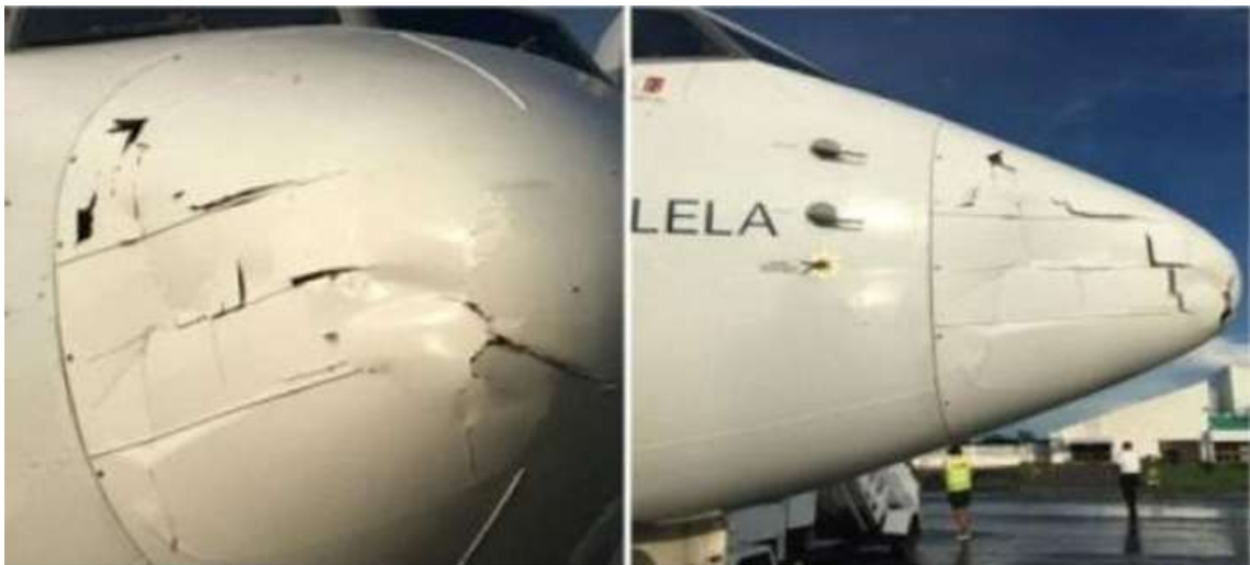
Figura 4: Acidente aeronáutico envolvendo um drone e uma aeronave.
