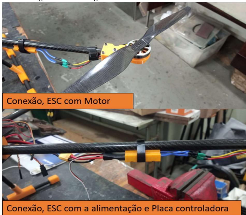
Figura 23: Montagem da conexão entre ESC e Motor
