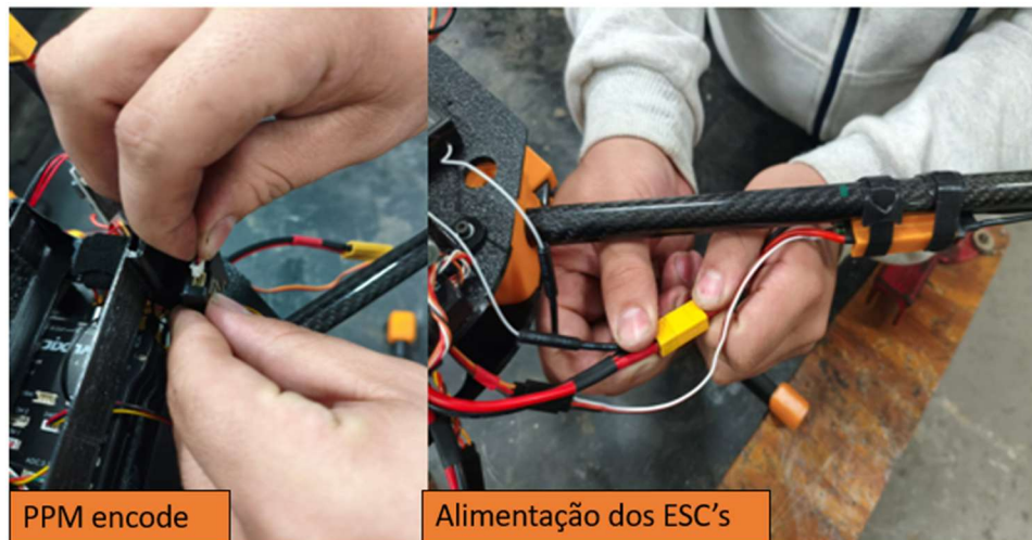
Figura 22: Interligando os componentes eletrônicos PPM e ESC
