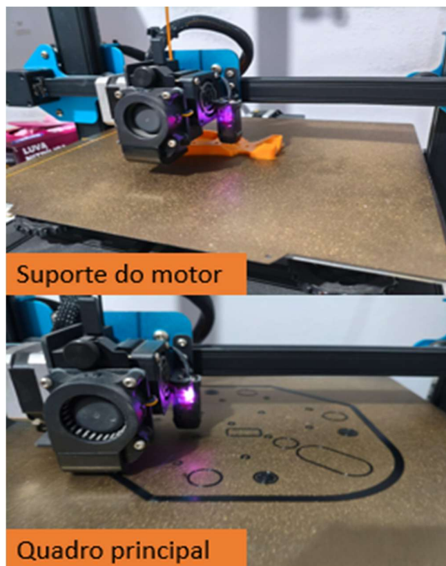
Figura 20: Manufatura aditiva do Suporte do motor e Quadro principal
