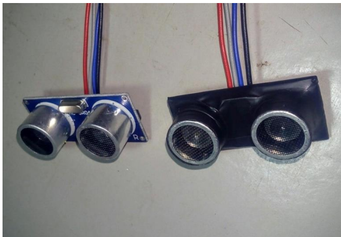
Figura 4.2 (H) – Sensor HC-SR04. FONTE: PRÓPRIO AUTOR
