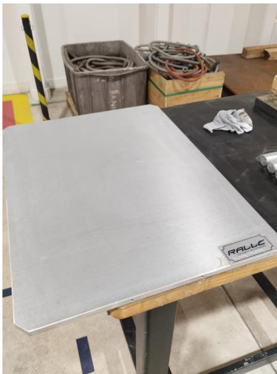
Figura 4. Molde de alumínio utilizado para laminação.
