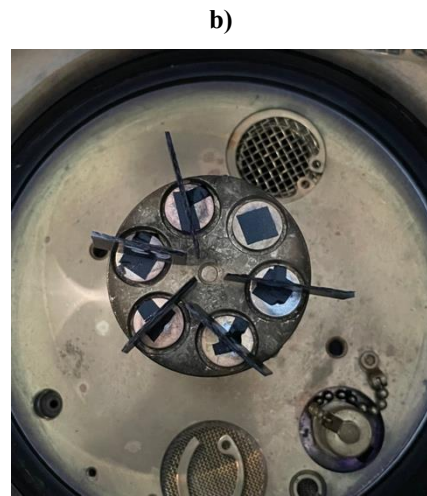
Figura 9. a) CDPs cortados para o MEV e b) Preparação dos CDPs para sputtering .
