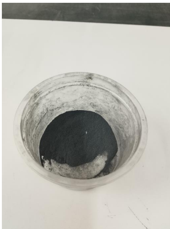
Figura 3. Resíduo de CRFC a partir do acabamento de peças aeronáuticas.
