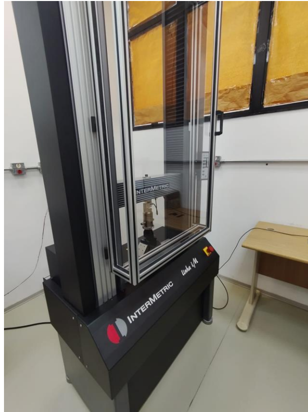
Figura 8. Máquina para ensaio de flexão - InterMetric.
