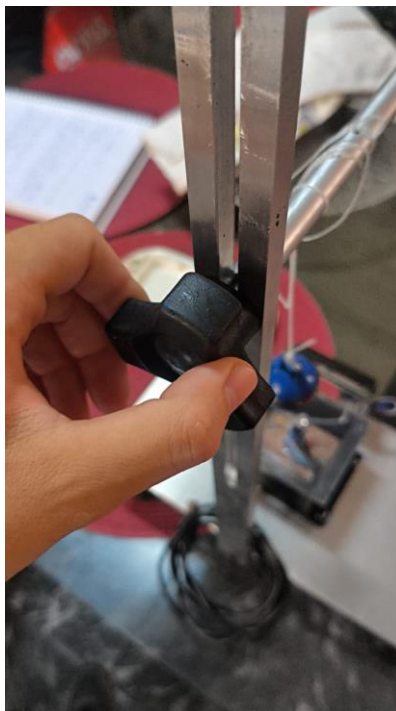
Figura 25. Processo de Montagem do Manípulo à Coluna
