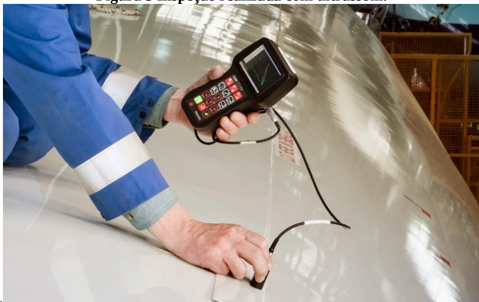
Figura 3 Inspeção realizada com ultrassom.
