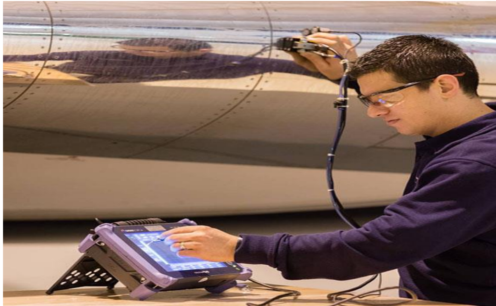
Figura 4 Inspeção realizada aparelho de correntes parasitas.
