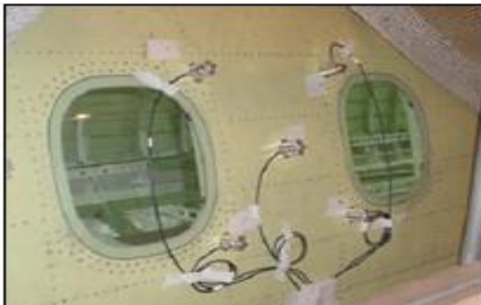
Figura 13. Painel da fuselagem com sensores de monitoramento
