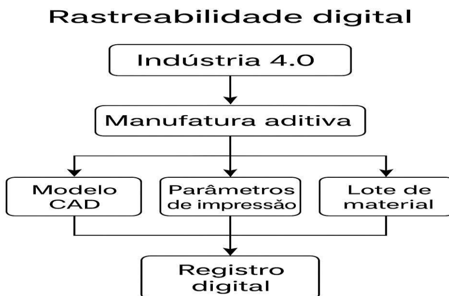
Figura 3 – Fluxo de rastreabilidade digital aplicado à manufatura aditiva.
