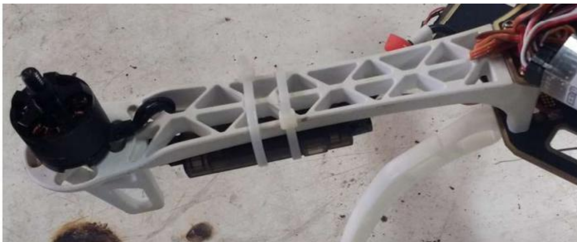
Figura 2 - Um dos braços do drone, sem a hélice. Em destaque, a posição e fixação do ESC. Nos modelos criados, ele foi simulado em uma posição mais próxima ao centro.
