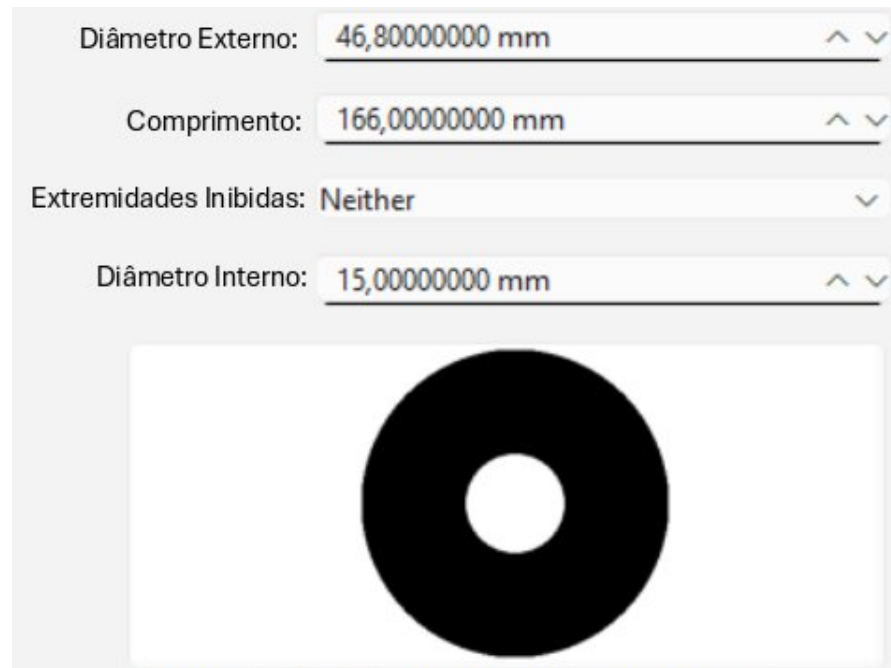
FIGURA 8. Corte simplificado de Grão Cilíndrico.
