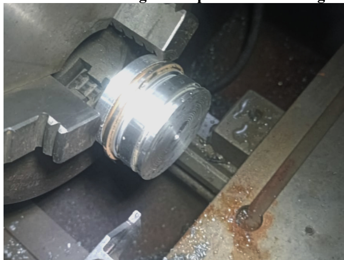
FIGURA 29. Diafragma em processo de usinagem.
