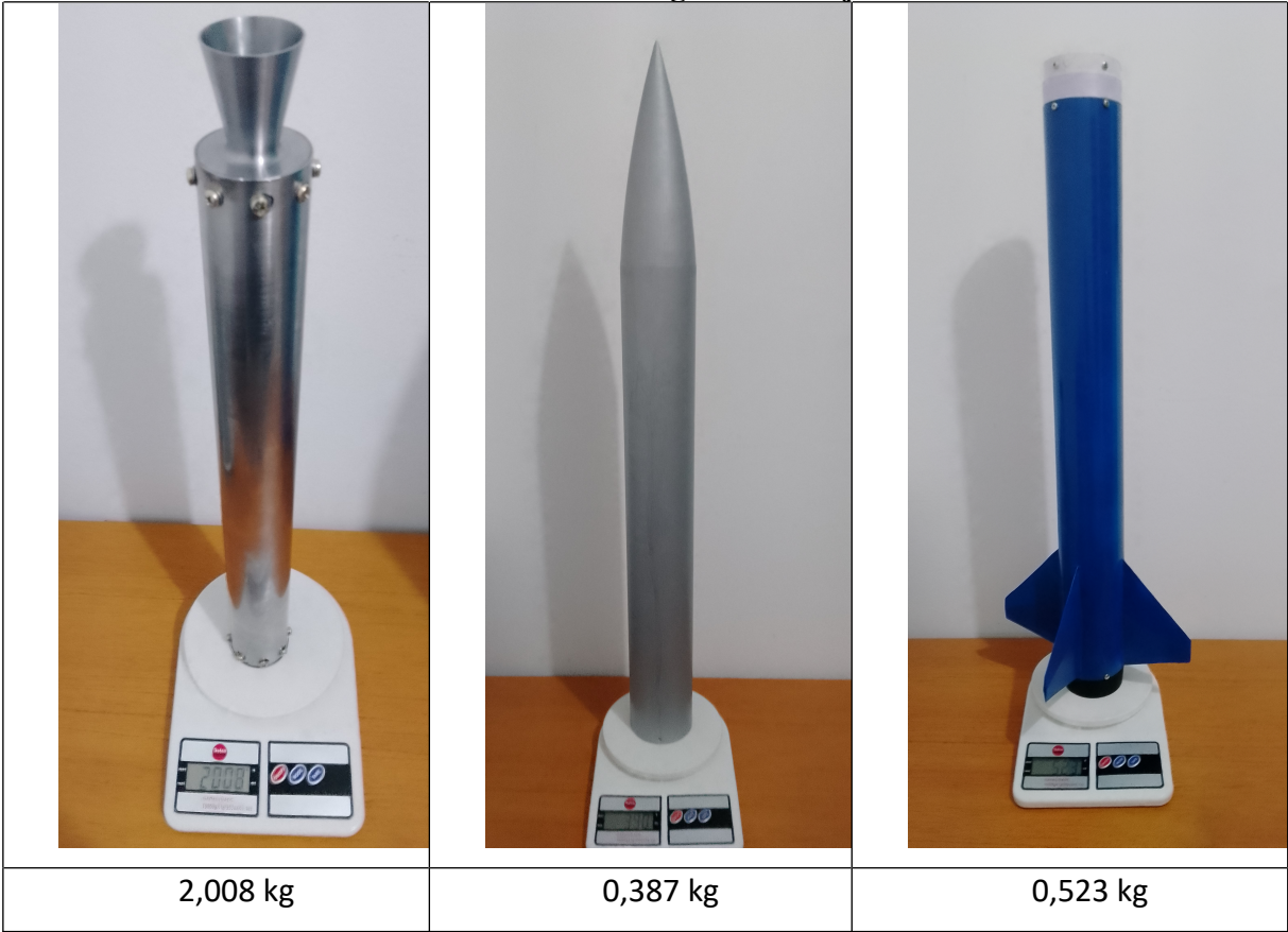
FIGURA 27 . Pesagem do Conjunto.
