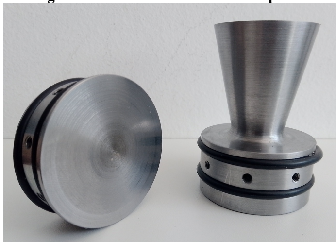
FIGURA 30. Diafragma e Tubeira resultado final do processo de usinagem.
