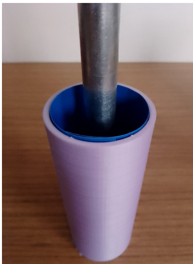
FIGURA 23. Molde e Mandril de Alumínio.
