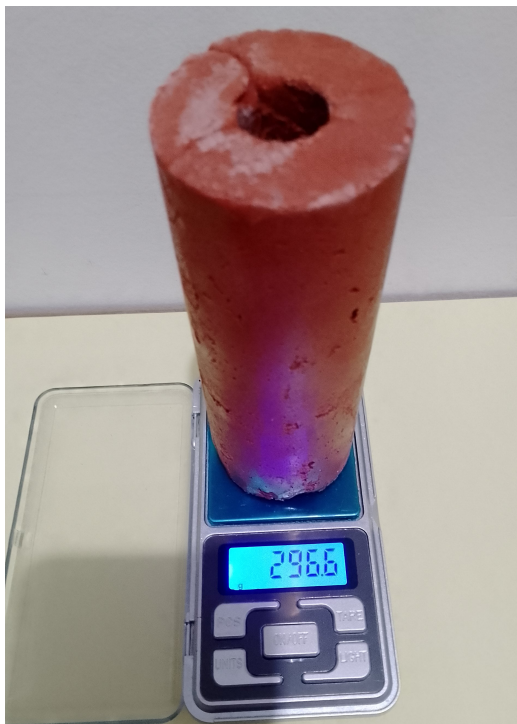
FIGURA 33. Ingredientes do Propelente Sólido após a Mistura.
