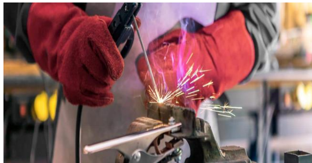
Foto 1: Solda por eletrodo revestido
