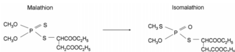
Figura 5. Transformação do Malathion em Isomalathion, por isomerização térmica ou fotoquímica.
