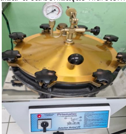
Figura 18. Autoclave de esterilização usada para realizar a carbonização hidrotermal
