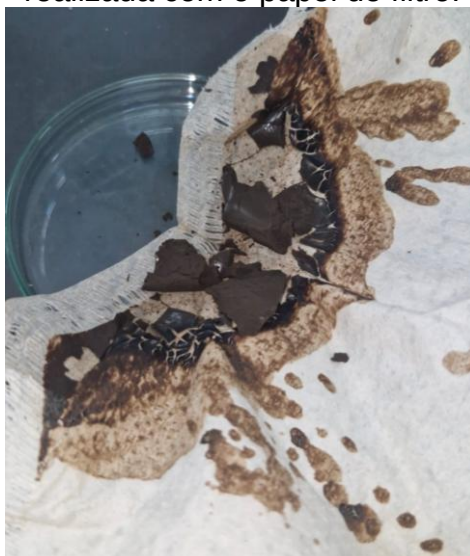
Figura 16. Resultado da primeira filtragem do lodo realizada com o papel de filtro.
