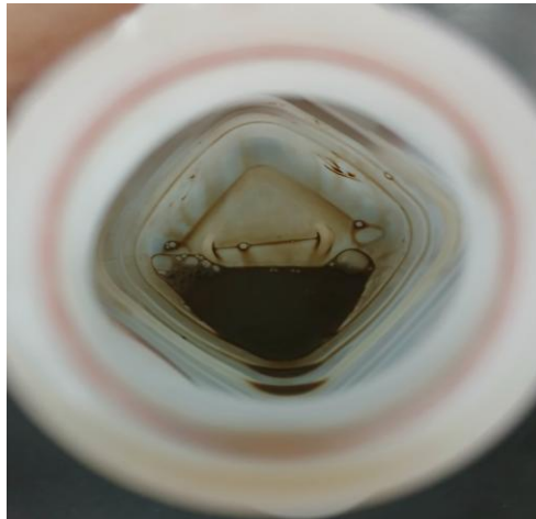
Figura 14. Primeiro lodo formado na sedimentação.
