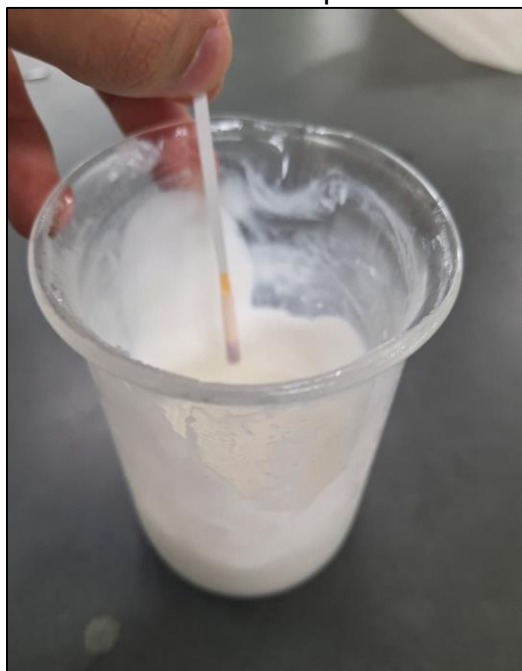
Figura 17 – Fita indicadora de pH inserida no produto
