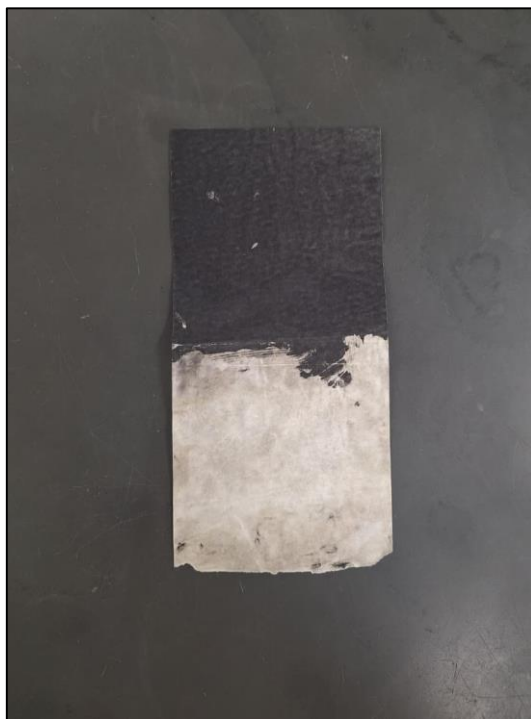
Figura 22 - Papel termo sensível após aplicação da chapinha e do leave-in em metade
